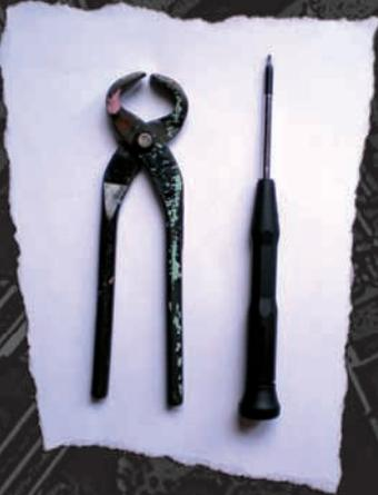
Akku rausnehmen und die darunter befindlichen Schrauben mit einem Torx 5-8 lösen. Wenn sowas gerade nicht da ist, das Gehäuse VORSICHTIG an den verschraubten Stellen auseinanderbrechen. Schicht für Schicht offenbart der Apparat sein komplexes Innenleben; der Motor kann überall sein))) Meistens sieht er so aus: Es gibt aber auch ganz andere...
